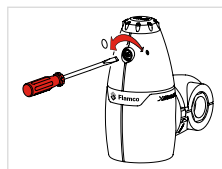
Justering af afluftningsventil
