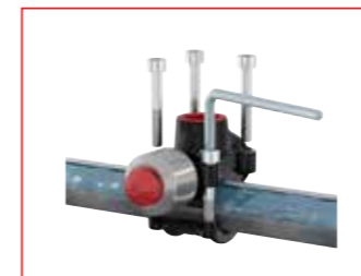
Fastgør T-plus på røret med fire bolte. Modeller fra 1½" er udstyret med click-in-møtrikker. Bolten klikkes på og skrues derefter på plads.
