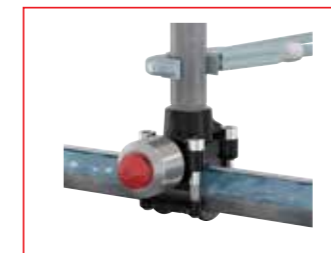
Stram boltene krydsvist. Brug tilspændingsmomentet, som er angivet i brugsanvisningen. Tilslut forgreningen. Kontrollér, at der ikke er vand i forgreningen, når T-plus aktiveres.
